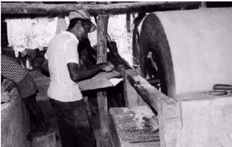
**Forno para secagem da farinha, o farinheiro verifica o ponto da farinha -
