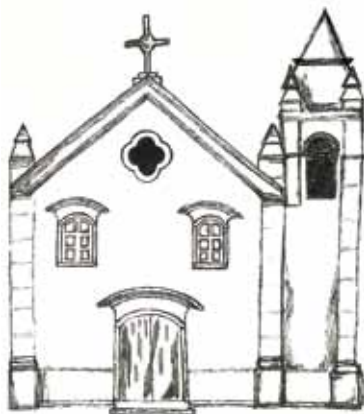
Exemplo de fachada com vãos em “V”
